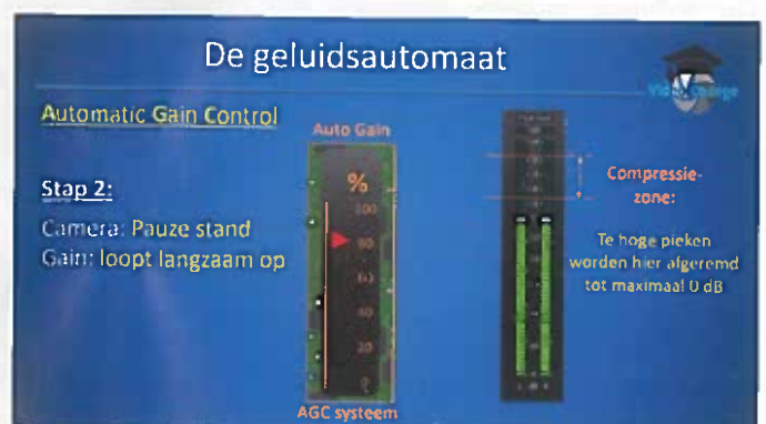
Figuur 4: Het niveau van de Gain gaat bij voorkeur naar de fabrieksinstelling tenzij...
